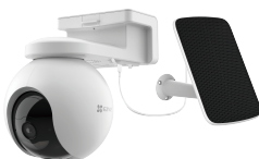
Chargement avec le panneau solaire
